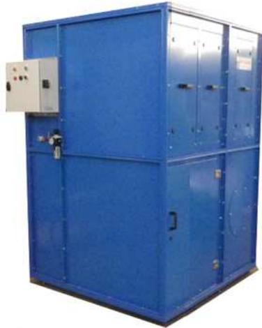
La construction du filtre en panneaux sandwich sur structure profilés aluminium garantit un niveau sonore faible, optimise le poids et la robustesse de l'appareil tout en garantissant une étanchéité vis à vis des poussières fines traitées. Il est mis en place facilement grâce à sa construction monobloc. Le ventilateur est fourni séparément, à installer dessus ou à côté.
