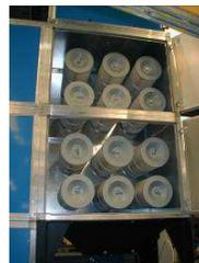
**NB :** Pour le remplacement des cartouches filtrantes, utiliser toujours des lunettes de protection et un masque respiratoire pour prévenir tout risque de contact et d'inhalation avec les particules collectées. L'alimentation électrique doit toujours être coupée par le sectionneur ou par les fusibles. Si le filtre est équipé d'une prise d'alimentation, celle-ci devra être détachée de son embrase murale.
