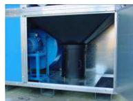
**NB :** Pour vider le(s) fût(s), utiliser des lunettes et un masque respiratoire de protection pour tout risque de contact et d'inhalation avec les particules collectées. L'alimentation électrique doit toujours être coupée par le sectionneur ou par les fusibles.
