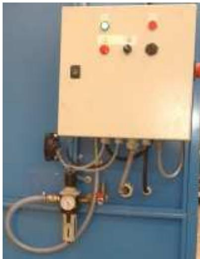
L'air comprimé doit être propre, déshuilé et équipé d'un assécheur d'air ayant pour pression utile 5 bars. Pour toutes autres informations consulter les services techniques ALW.
