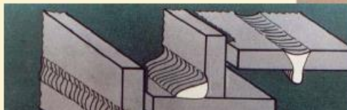
Les défauts de soudure
