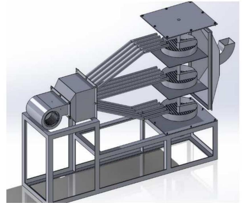
Les matériaux humides sont introduits en continu à la couche supérieure de séchage. Ils seront tournés et agités en permanence par des palettes à bras rotatifs. Le matériau traverse la surface de la plaque de séchage le long de la ligne hélicoïdale exponentielle.
