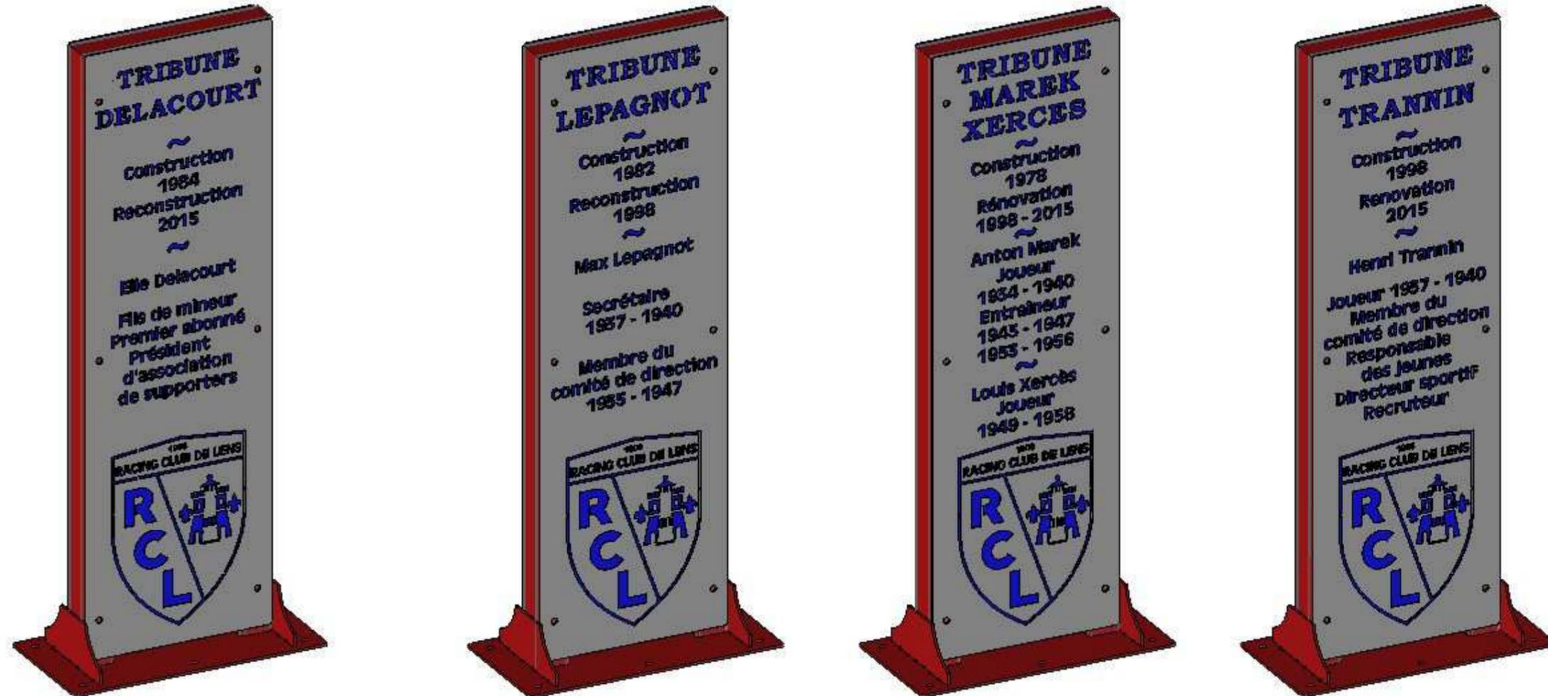
Le totem est composé d'un châssis tubulaire en tube carré de 100, d'une semelle en tôle d'ep. 8mm et de 2 goussets, de 2 panneaux arrières d'épaisseur 1.5mm et de 2 panneaux signalétiques en tôle d'ep. 3 mm;
