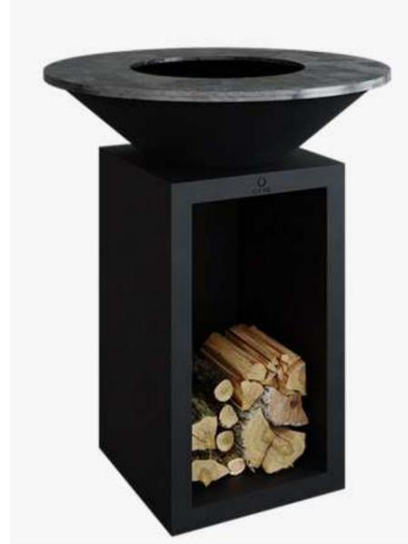
L'Unité de cuisson est composé d'un socle en tôle pliée d'ep. 2.5mm avec 4 pieds réglables, d'un tronc de cône d'ep.2.5mm sur lequel est posé la plaque de cuisson en tôle d'acier ep 10mm.
