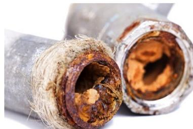
Les boues présentes dans les circuits de chauffages domestiques ou collectifs sont issues de la corrosion des différents éléments constitutifs de l'installation, tuyauterie, chaudière, émetteurs, vannes, circulateurs, etc. . .
