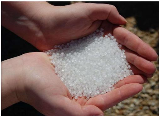
C'est un produit semifini souvent utilisé en plasturgie, notamment pour les procédés d'extrusion et d'injection ; cette forme est très pratique à stocker, à manipuler, et bien adaptée aux processus (remplissage aisé des machines et malaxage facilité).
